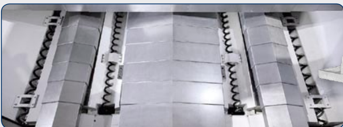
Evacuazione centrale con 4 coclee + tapparella in acciaio - 4 screw type chip conveyors + steel belt type chip conv.
