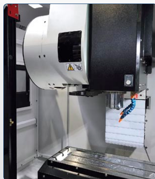
Versione con cambio utensili a 16 posizioni Arm type 16 positions
